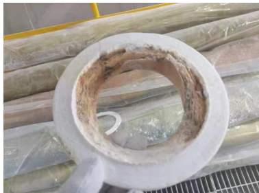
フランジ圧潰・破折 原因：フランジの強度不足です。
