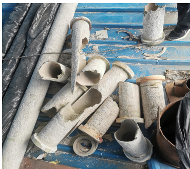
フィルターエレメント破断：主にフランジから30-60cmの位置で発生します。
