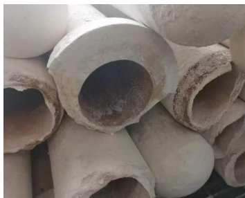
フランジ圧潰・破折 原因：フランジの強度不足です。
