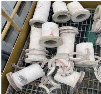
フィルターエレメント破断：主にフランジから30-60cmの位置で発生します。
