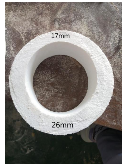
内壁肉厚のバラツキ大 原因：製造工程の欠陥によるものです。
